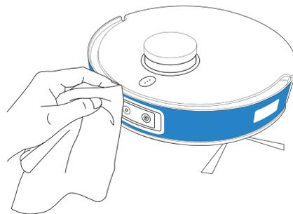
\* 请用干净的软布擦拭传感器镜片和TrueMapping激光扫描模块，不要用洗剂、洗衣液、喷雾器。
