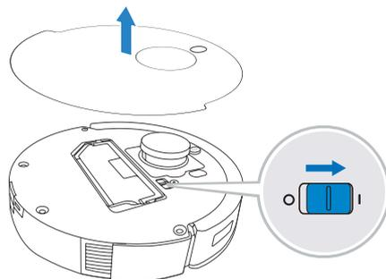
**!** 请注意，主机无法在电源关闭的情况下充电。
