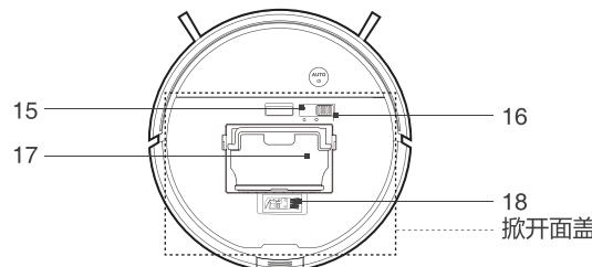
15. 重置键（配网时：按一下 键，听到主机提示音，主机进入配网模式；恢复出厂设置：长按 键三秒，开机音乐响起，主机恢复出厂设置，请谨慎使用此键。）
