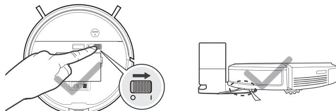
电源关闭时，主机红灯闪烁无法充电，充电前，请确保主机电源开关处于“I”的位置。
