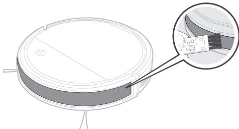
清理充电极片，请使用干抹布分别清理主机底部或充电座的充电极片。
