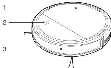
1. 面盖 2. 控制面板 3. 红外缓冲防撞板 4. 水箱释放键
