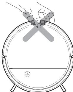
请勿单手搬动主机，以免误触水箱释放键，导致整机掉落。
