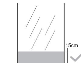
充电座前方 4m 及左右 1m 范围内不要有镜子等反射面较强的物体，如有请用纸板或布将其底部 15cm 高的区域遮挡起来。
