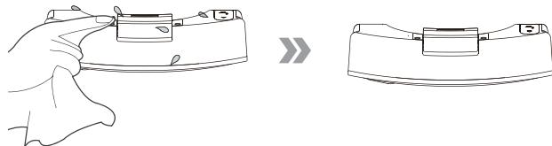
\* 若水箱渗水不均匀、速度过慢时，请拆下水箱底部的滤网固定螺丝，取下滤网并及时清理。
