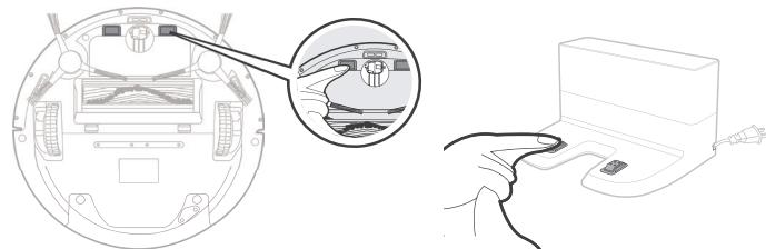
\* 若长时间不使用产品，储存前请先将其充满电，再关闭电源开关，并坚持每3个月为其补充电，以防电池过放。
