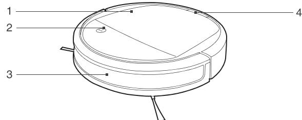
1. 面盖 2. 控制面板 3. 红外缓冲防撞板 4. 水箱释放键
