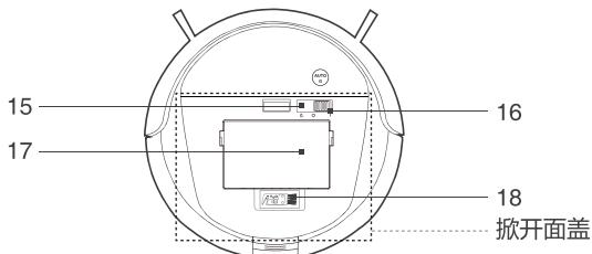
15. 重置键 (配网时：按一下 键，听到语音提示音，主机进入配网模式；恢复出厂设置：长按 键 3 秒，开机音乐响起，主机恢复出厂设置，请谨慎使用此键。)
