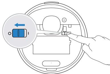
**!** 请注意，主机无法在电源关闭的情况下充电。
