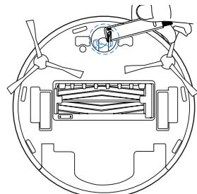
**温馨提示：**充电极片内部包含敏感的电子元件，清理时请使用干抹布，请勿使用湿抹布以防进水造成损坏。
