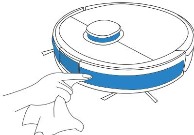
\* 请用干净的软布擦拭AIVI视觉识别传感器镜片和TrueMapping激光扫描模块，不要用清洗剂、洗衣液、喷雾器。
