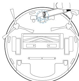
**温馨提示：**充电极片内部包含敏感的电子元件，清理时请使用干抹布，请勿使用湿抹布以防进水造成损坏。
