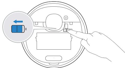
**!** 请注意，主机无法在电源关闭的情况下充电。
