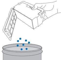
3 Step 拆下精细过滤棉和高效过滤组件。
