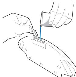
**3** Step 盖上橡皮塞，贴好抹布，将抹布和水箱一起装入主机。
