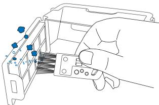
5 Step 拍打高效过滤组件，用水冲洗尘盒和精细过滤棉。
