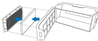
4 Step 用清理小工具的毛刷清理初级滤网上的灰尘，注意里外两面都要清理。
