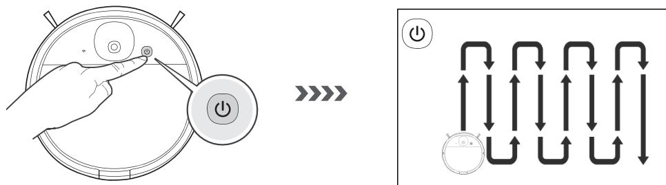
**温馨提示：**当只需要清扫单个房间，请关好房门，主机在房间内进行集中清扫，若这个房间无充电座，清扫完返回原点。
