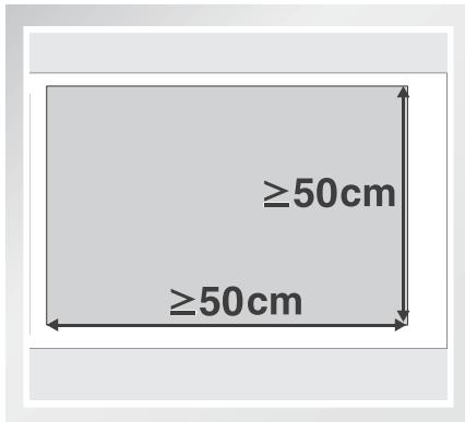
请在面积  $\geq 50 \times 50\text{cm}$  的有框或无框玻璃上使用本产品。
