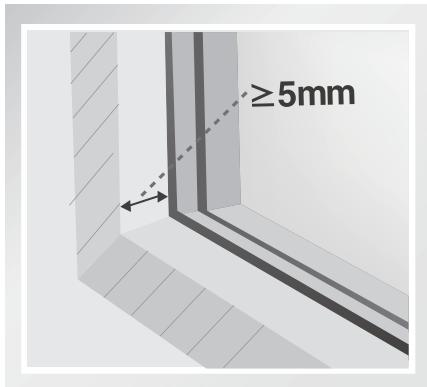
严禁在边框厚度（玻璃面到边框面的高度差） $< 5\text{mm}$ 的有框玻璃上使用本产品。
