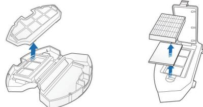
4 用清理小工具的毛刷清理初级滤网上的灰尘，注意里外两面都要清理。
