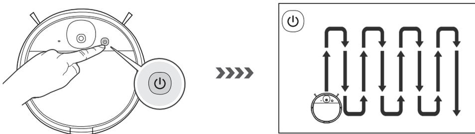
**温馨提示：**当只需要清扫单个房间，请关好房门，主机在房间内进行集中清扫，若这个房间无充电座，清扫完返回原点。
