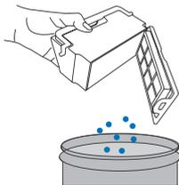
**3** Step 拆下精细过滤棉和高效过滤组件。
