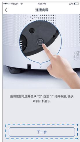
**Step 3 重置网络:** 用尖锐物体戳一下主机下部
