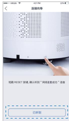
**4 Step** 连接“ECOVACS\_XXXX”网络：点击“去连接”，在转的页面中选择“无线局域网”，在网络列表中找到并连接“ECOVACS\_XXXX”网络，连接成功后点击【科沃斯机器人】或者手动切换到机器人 App 页面。等待系统自动配置即可。
