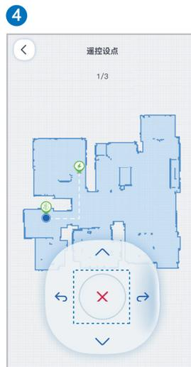
**2** Step 点击 **MOVE**，主机自主回到第一个净化点开始净化，净化完成后，自主移动到第二个、第三个净化点，依次净化。
