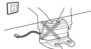
为了方便主机清扫和更好地返充，请勿随意、频繁搬动充电座，若充电座位置改变，主机可能定位失败丢失地图，再次工作时，主机将重新建立并记忆地图。
