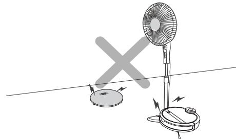
主机执行工作时，请保证清扫区域内勿放置最低边缘不足 1.8 厘米的物体，如：落地扇底座等，防止主机攀爬卡住。
