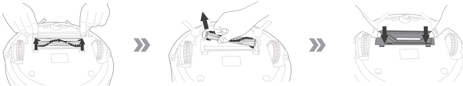
**滚刷安装：**取出吸口组件，将滚刷装入滚刷槽，安装滚刷盖板，按压成功锁定。
