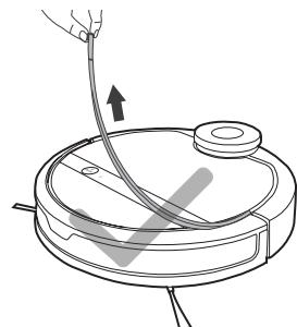
使用前，请务必移除地宝撞板上的防护条，以确保主机正常使用。
