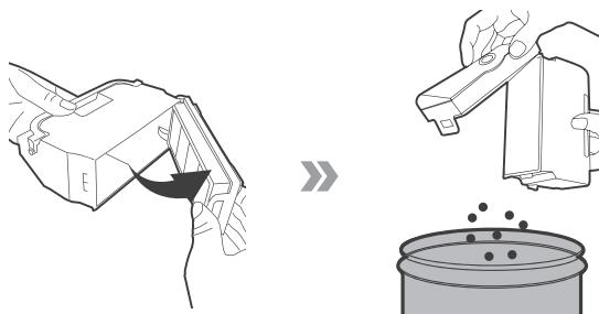
取下滤材组件；高效过滤组件 (HEPA) 不建议水洗，可轻拍去灰。
