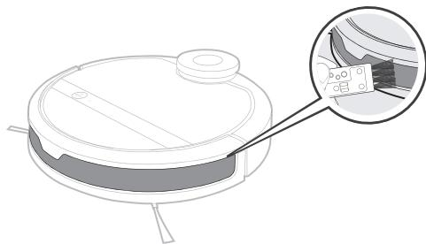
清理充电极片，请使用干抹布分别清理主机底部或充电座的充电极片。
