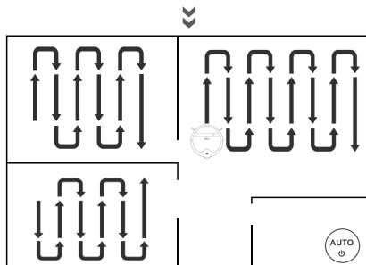
工作中，请勿随意、频繁搬动主机。搬动后，请将主机放到原地附近，再次启动时主机将尝试按照规划好的路径继续工作。
