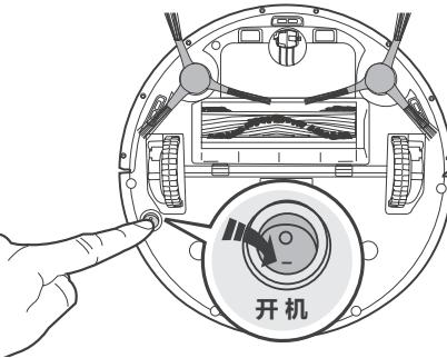
电源关闭时，主机红灯闪烁无法充电，充电前，请确保主机电源开关处于“I”（开机）的位置。
