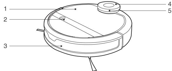
1. 面盖      3. 前视防撞感应器      5. 激光扫描模块 ( LDS ) 防撞板
