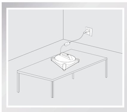
请连接电源，若开机后，状态指示灯绿灯闪烁，确保其充电至蓝灯闪烁。产品在绿灯闪烁的情况下不建议执行清洁工作。
