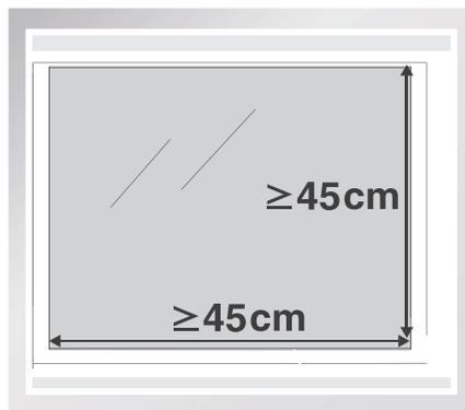
请在面积  $\geq 45*45\text{cm}$  的有框或无框玻璃上使用本产品。
