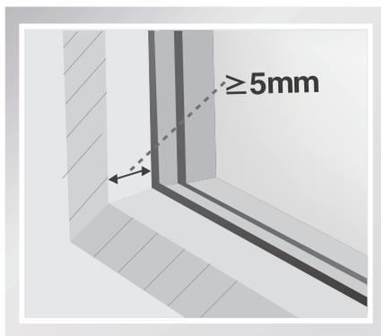
严禁在边框厚度（玻璃面到边框面的高度差）小于 5mm 的有框玻璃上使用本产品。
