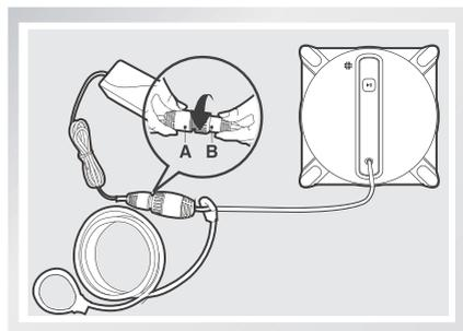
**3** 取出 D 套入 C, 拉紧安全绳端, 固定安全扣。
