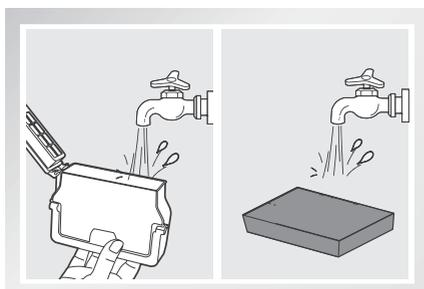
拆下滤材组件。高效过滤组件（HEPA）不建议水洗，可轻拍去灰。
