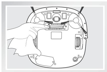
清理边刷：拔出边刷，用干净的清洁布将边刷和边刷槽擦拭干净。
