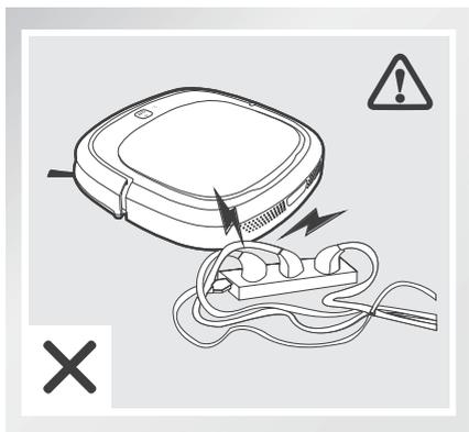
散落地面的电源线等杂物可能绊住或缠绕产品，使用前请务必移除。
