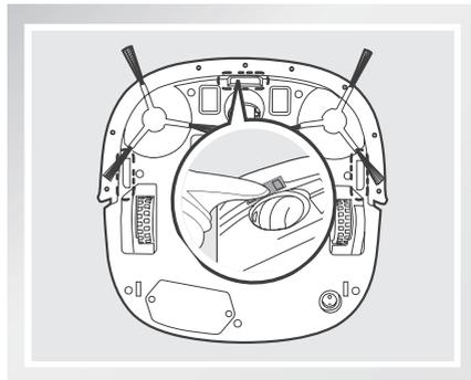
清理充电极片，请使用干抹布分别清理主机底部和充电座的充电极片。
