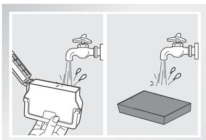
拆下滤材组件。高级过滤 HEPA 不建议水洗，可轻拍去灰。
