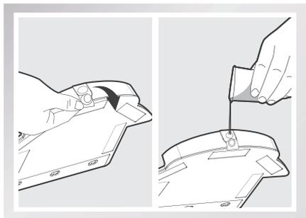
**加水：**打开注水口盖，用量杯接足水，将水缓慢注入蓄水器中。
