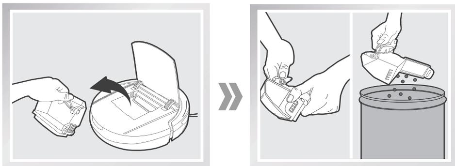
取下滤材组件；高效过滤 HEPA 不建议水洗，请轻轻拍去灰。
