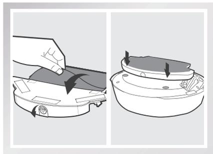
**安装：**盖紧注水口盖，黏贴好清洁布，将清洁布组件安装至主机底部。
