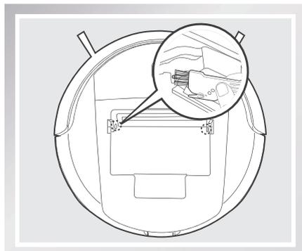
清理充电极片，请使用干抹布分别清理主机或充电座的充电极片。
